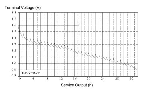
Figure 2: GLR20A DISCHARGE CURVE
